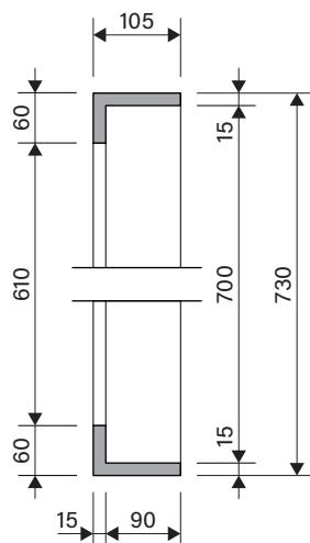
Die Massangaben in mm verstehen sich unter dem Vorbehalt der Werkstoleranzen, eventuell späterer Änderungen sowie weiterer Montagemöglichkeiten. Die Haftung für Folgen fehlerhafter oder unvollständiger Massangaben ist ausgeschlossen (Art. 100 OR).
