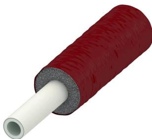
**TECElogo Mehrschichtverbundrohr vorgedämmt, 9 mm Dämmung, rot****Artikelnummer:** 8702025**Dimension:** 25 - RS 9 mm**Material:** PE-RT type II/Al/PE-RT type II**LE 1:** 50 m**LE 2:** 150 m**LE 3:** 300 m**Beschreibung:**
